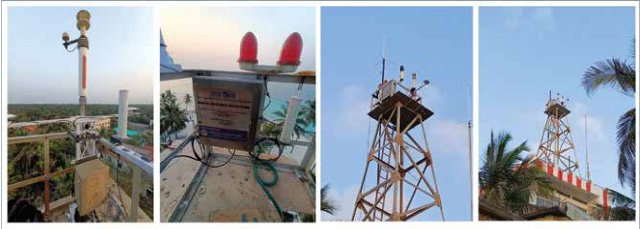
चित्र 6.9 पोर्ट कंट्रोल टॉवर, कवरत्ती में नव स्थापित स्वचालित मौसम स्टेशन
