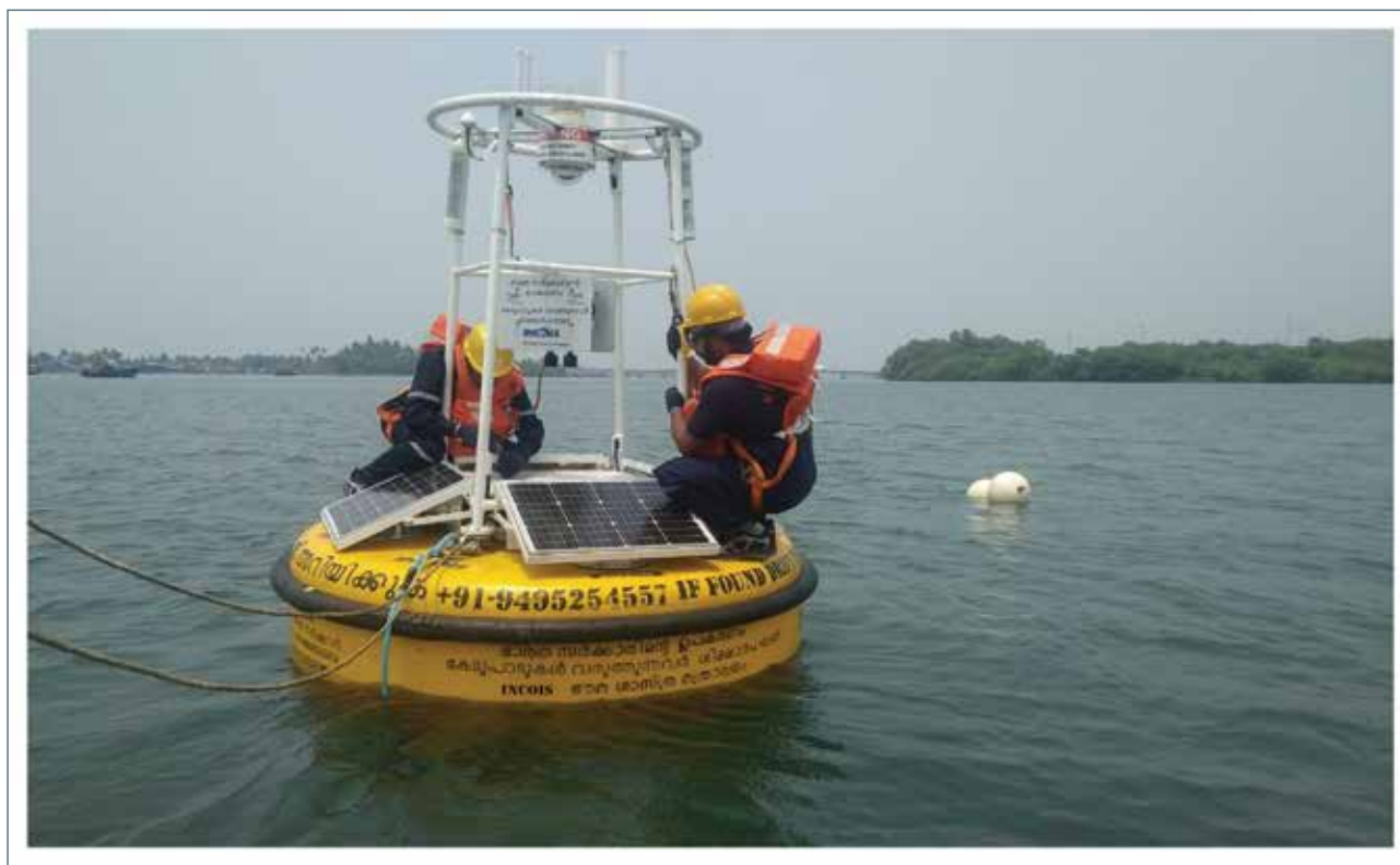
चित्र 6.19 03 मार्च 2022 को कोच्चि के पास मुहाने क्षेत्र में जल गुणवत्ता निगरानी बॉय का परीक्षण परिनियोजन
